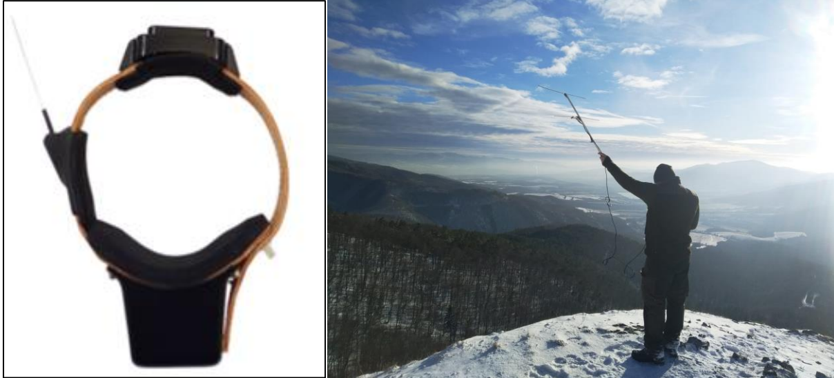
Obr. 9 Telemetrický obojok od firmy Lotek vhodný pre monitoring mačky divej (vľavo); zameriavanie aktuálnej pozície zvieratá s využitím VHF signálu - na rovnakom princípe bude možné dohľadať aj odpojený obojok (vpravo).
